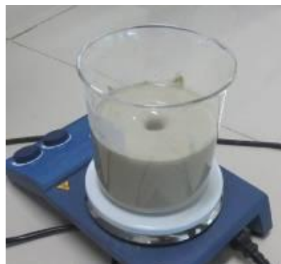
Gambar 1. Proses pembuatan larutan induk TiZA
