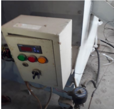
Gambar 4. Regulator Terpasang pada Alat Penyangraian
